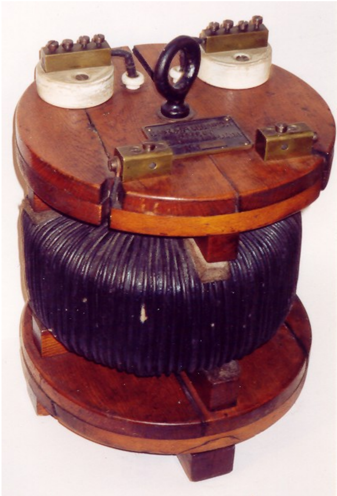
1896 januárjában készült őstranszformátor a montevideói villamosmű részére. (Magyar Műszaki és Közlekedési Múzeum gyűjteményéből)
